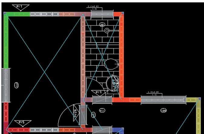
As lajes são atualizadas automaticamente com as movimentações das paredes e os contornos são identificados automaticamente. O usuário não precisa mais conectar manualmente as linhas de carga para que o programa reconheça o contorno, basta que as paredes se cruzem e que os fechamentos de bordo toque num bloco da parede.
