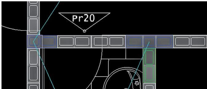
As cercas de paredes não existem mais, já que o elemento base é a própria parede. As cercas de subestruturas verticais e de vento são geradas automaticamente sem intervenção do usuário, e os tamanhos das abas de cada subconjunto é editável.
