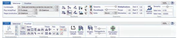
Os elementos visíveis podem ser facilmente selecionados no Ribbon, por tipo (Ex: vigas, lajes, pilares, etc.), ou por direção (X, Y ou Z). Há também uma opção para eliminar as barras completamente do modelo ou apenas esconder os diagramas.
