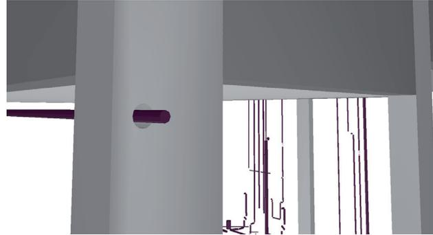
A importação de tubulações do BIM fura pilares automaticamente, de maneira que o modelo estrutural retorna para o modelo BIM com os furos corretamente posicionados. Tubos editados ou gerados pelo usuário tem preferência sobre furos importados. O TQS não leva em consideração os furos em pilares no dimensionamento, assim os pilares com furos receberão uma tarja avisando a necessidade de verificação.
