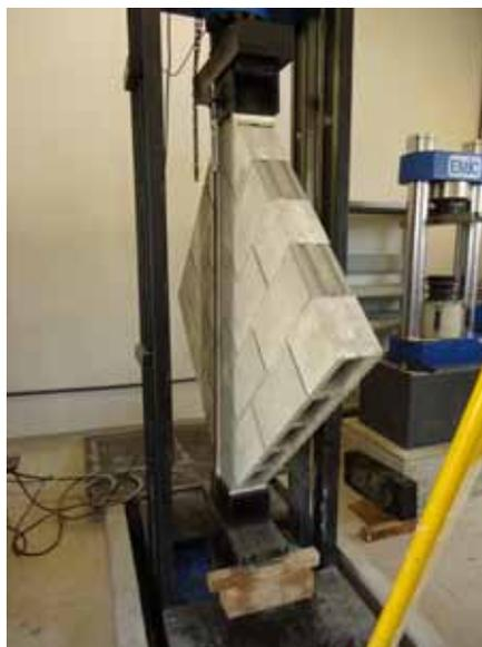
*Ensaio de Cisalhamento – Blocos de Concreto – Laboratório de Sistemas Estruturais - UFSCAR*
