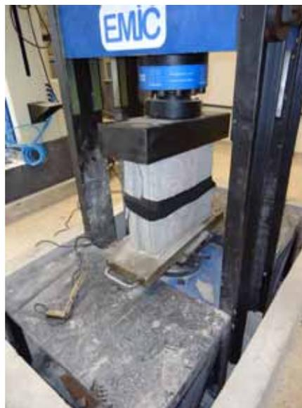
*Ensaio de Prisma - Blocos de Concreto - Laboratório de Sistemas Estruturais - UFSCAR*
