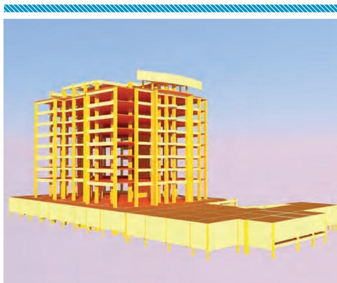
(num determinado pavimento onde existe uma laje) a um nó “mestre” de forma a simular o Diafragma rígido.
