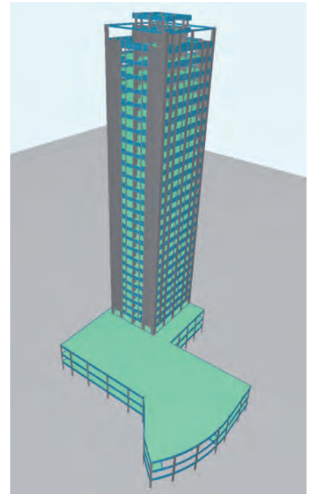
Edifício - Paredes de Concreto - Modelo 3D - TQS
