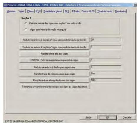
Reparem que o divisor/redutor de inércia à torção para vigas sem predominância de torção neste projeto é 20. No caso, lucidamente, depois de alguns processamentos, escolhi no modelador as vigas com predominância de torção e lá defini os redutores/divisores de torção para cada uma delas, sendo que, em alguns casos, o motivo seja o equilíbrio e em outros casos, compatibilização de esforços entre os elementos estruturais.
