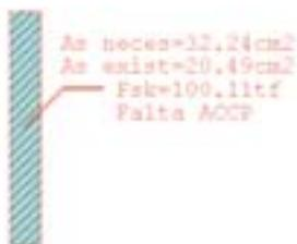
Além da verificação à punção, foi criada uma verificação de força cortante em regiões maciças de concreto. Esta verificação ajuda a localizar outras regiões da laje que devem ser armadas ao cisalhamento, mas que não tenham sido dimensionadas à punção. O Editor de Esforços mostra (mas não detalha) os pontos da grelha onde a armadura de cisalhamento é necessária:
