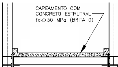
Detalhe de capeamento do tabuleiro
